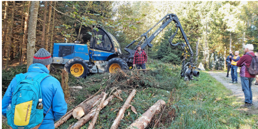
Bei Posten zwei trafen die Teilnehmenden in einer sogenannten Rückegasse auf Forstunternehmer Hans Habegger. Dieser erklärte den Einsatz des Vollernters zwecks Fällung und Entastung der Bäume. Fotos: Murielle Buchs
